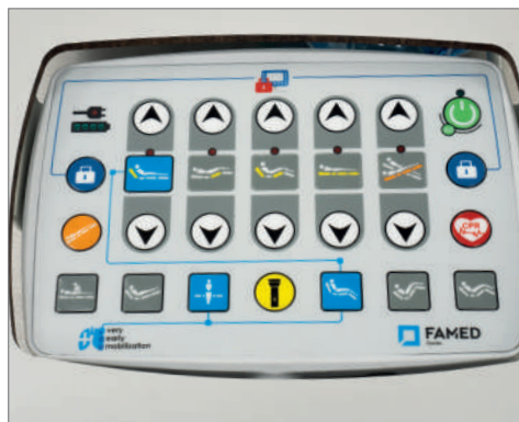
Центральная панель (supervisor) среди прочего с функциями VEM, положениями, доступными при помощи одной кнопки, и электрическим CPR.
