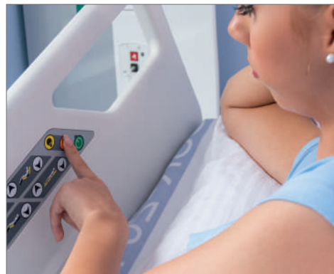
Панель для слепых и слабовидящих (профилированные 3D-кнопки, контрастные обозначения).
