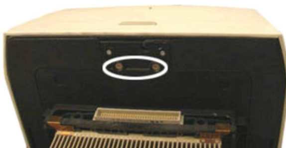
Рис. 108. Удалите данные винты для открытия оптического модуля
