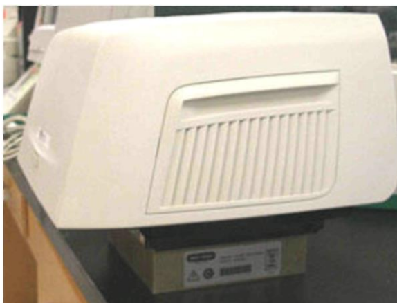
Рис. 107. Установка оптического модуля для демонтажа стопорной пластины
