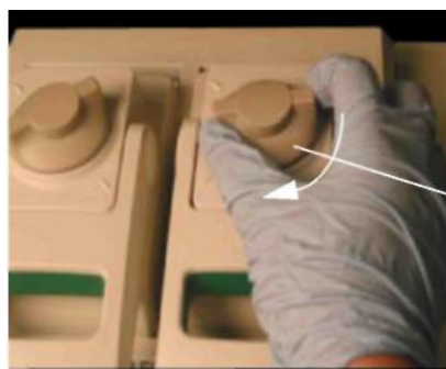
Повернуть головку на 1/4 оборота, чтобы увеличить усилия зажима
