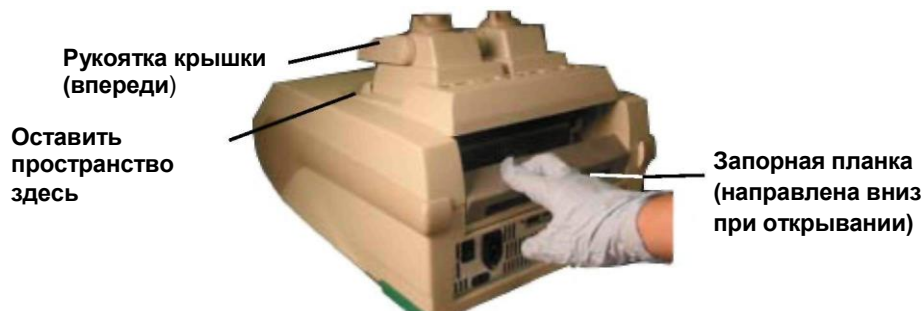
Рисунок 4. Установка модуля для проведения реакций в отсек.
